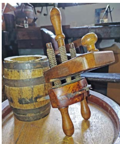
Die umlaufende Nut zur Fixierung der Fassböden wird mit einem speziellen Nuten-Hobel („Kimmhobel“) herausgearbeitet
