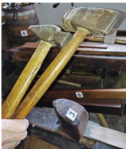
Setzen der Fassreifen mit Schreinerhammer (links) und Setzhammer mit Rille (rechts), letzterer mit einem Holzstück auf der Oberseite zur Abfederung der Schläge mit dem Schreinerhammer
